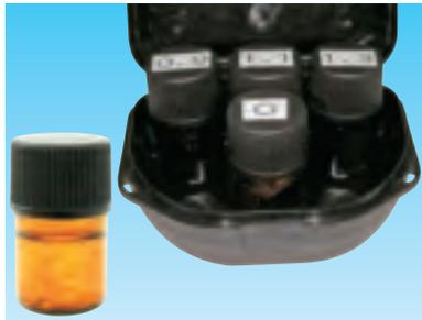
図8 Pre-Impregnation Technique。遮光瓶の中で光重合モノマーに浸漬し、遮光ケースに入れてサイズごとに分けて保存している。
